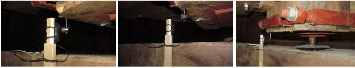
Sensor (reed-contact) en magneetje onder bij koningsspil.
